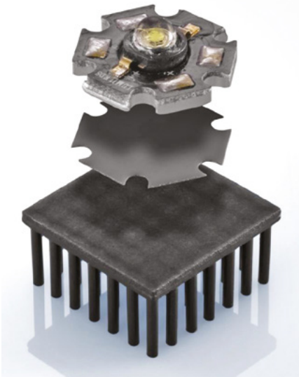
Fotografia 20. Sposób montażu modułu „star” na radiatorze – przekładka zwiększa powierzchnię styku termicznego pomiędzy ALPCB i powierzchnia radiatora
