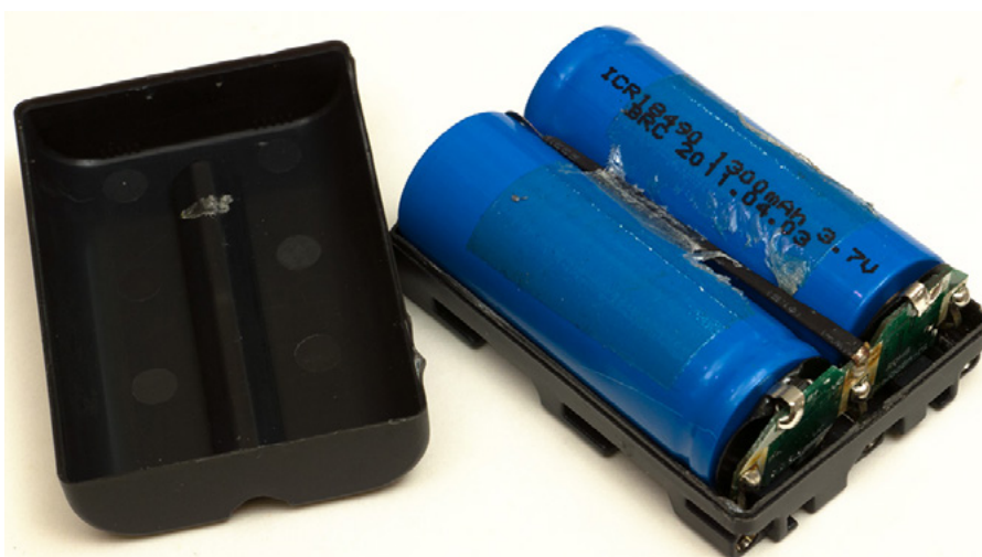
Fotografia 6. Akumulatory do aparatów, kamer i laptopów najczęściej zawierają dwa lub więcej akumulatorów cylindrycznych
