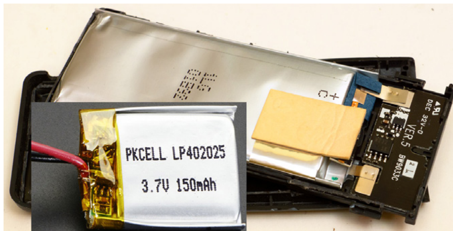
Fotografia 27. Przykładowe akumulatory z wbudowanym zabezpieczeniem
