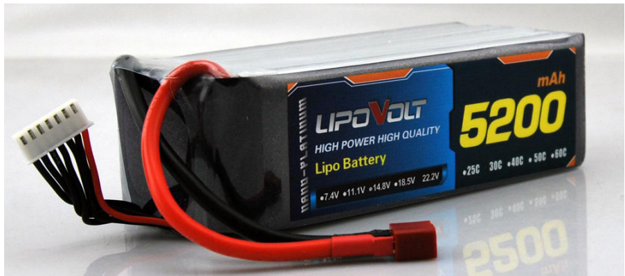
Fotografia 13. Akumulator modelarski o napięciu 22,2 V (6 ogniw)
