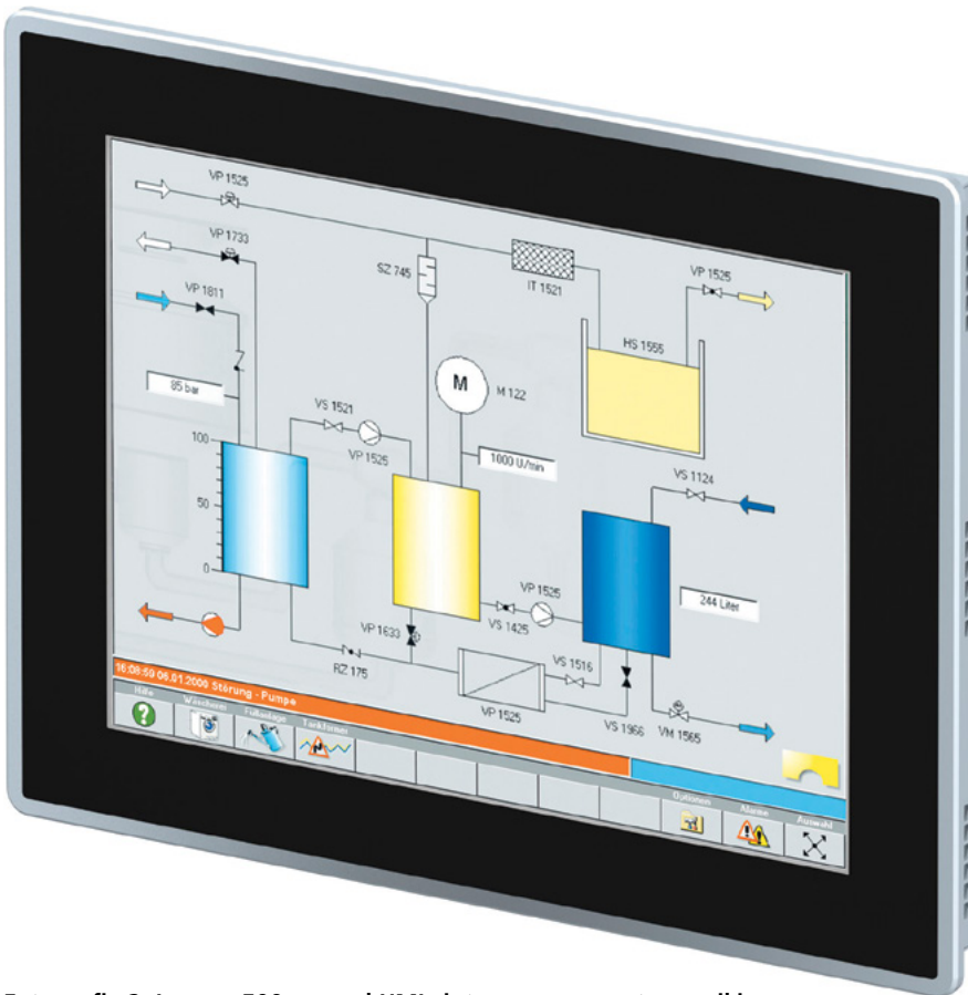
Fotografia 2. Lenze p500 – panel HMI zintegrowany ze sterownikiem
