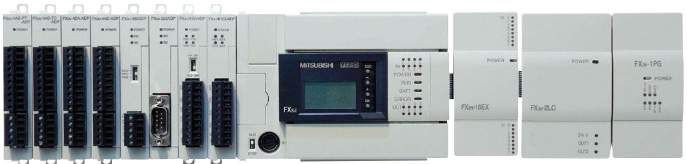
Fotografia 5. Duży, samodzielny sterownik PLC firmy Mitsubishi
