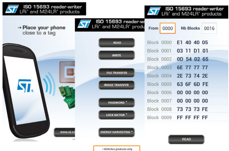
Rysunek 8. Przykładowe ekrany aplikacji na Android do obsługi via NFC pamięci M24LR
