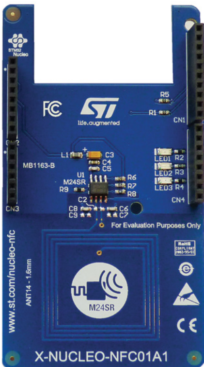
Fotografia 6. Wygląd ekspandera X-CUBE-NFC1 dla płytki STM32NUCLEO
