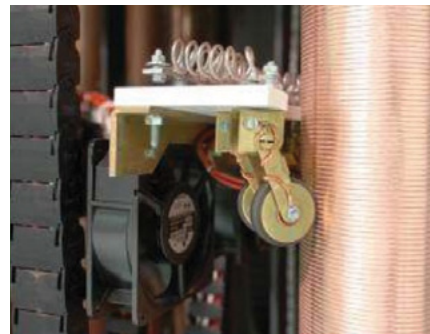
Fotografia 3. Kolumna regulatora napięcia z rolką
