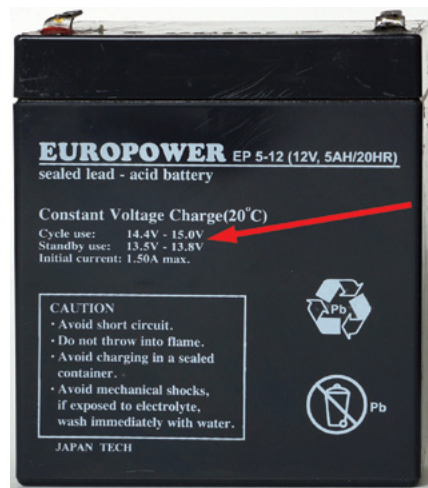
Fotografia 15. Na obudowach niektórych akumulatorów jest podany maksymalny prąd ładowania oraz dwa zakresy napięcia
