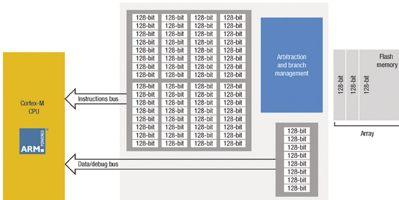
Rysunek 3. Uproszczony schemat blokowy interfejsu ART, który w STM32F7 służy przyspieszeniu odczytu danych z pamięci Flash
