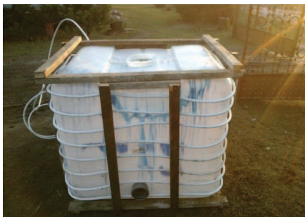
Fotografia 4. Zbiornik owinięty węzłem od ogrzewania podłogowego
