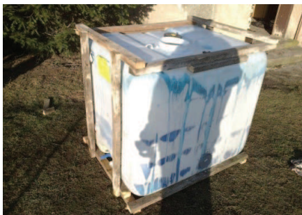
Fotografia 3. Zbiornik obudowany drewnianym stelażem
