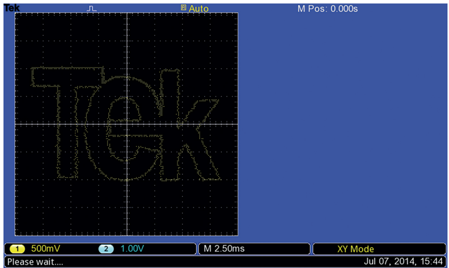
Rysunek 5. Przykład pracy układu akwizycji w trybie XY
