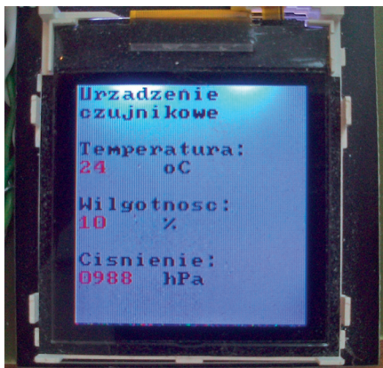
Rysunek 13. Mikrokontroler wyświetla na wyświetlaczu dane z czujników
