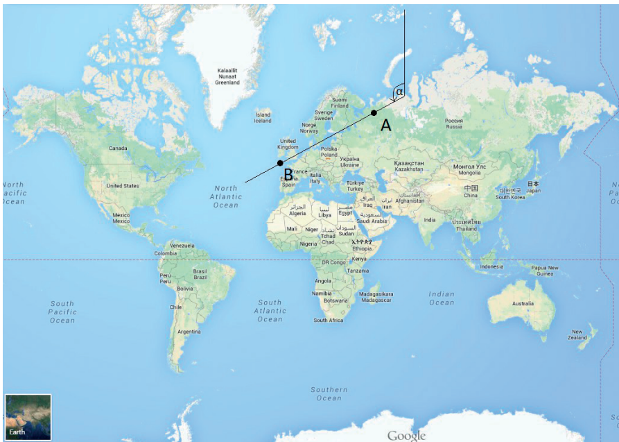
Rysunek 7. Punkt aktualny (A) oraz punkt docelowy (B) tworzą prostą o pewnym kącie nachylenia ( \alpha ) względem południka
