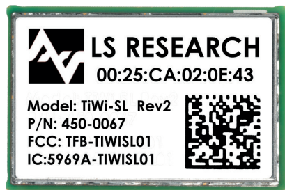
Fotografia 5. Moduł LS Research TiWi-SL
