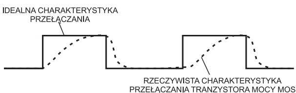
Rysunek 2. Charakterystyka przełączenia tranzystora w rzeczywistej aplikacji
