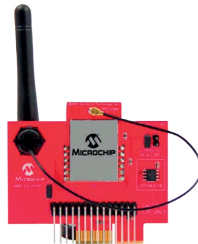
Fotografia 1. Moduł Microchip MRF24J40MC na płycie drukowanej, z przymocowaną, zewnętrzną anteną
