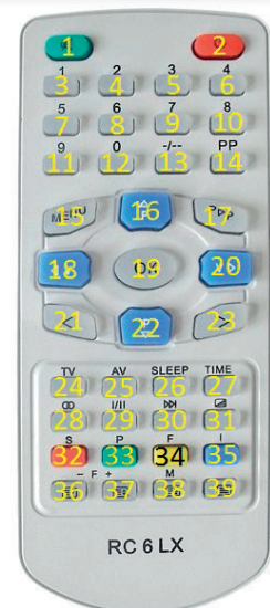
Rysunek 5. Numeracja przycisków nadajnika IR
