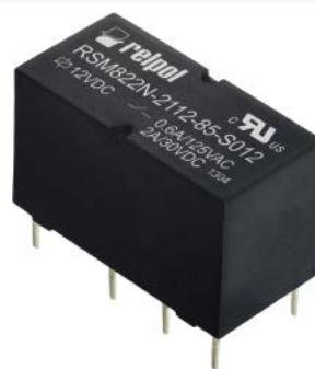
Fot. 3. Przekaźnik subminiaturowy RSM822N, 2 zestyki przełączne, znamionowy maksymalny prąd obciążenia 0,6 A/125 VAC, maks. 3 A 30 VDC
