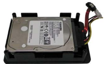
Fotografia 4. Montaż dysku HDD w obudowie Cubietruck
