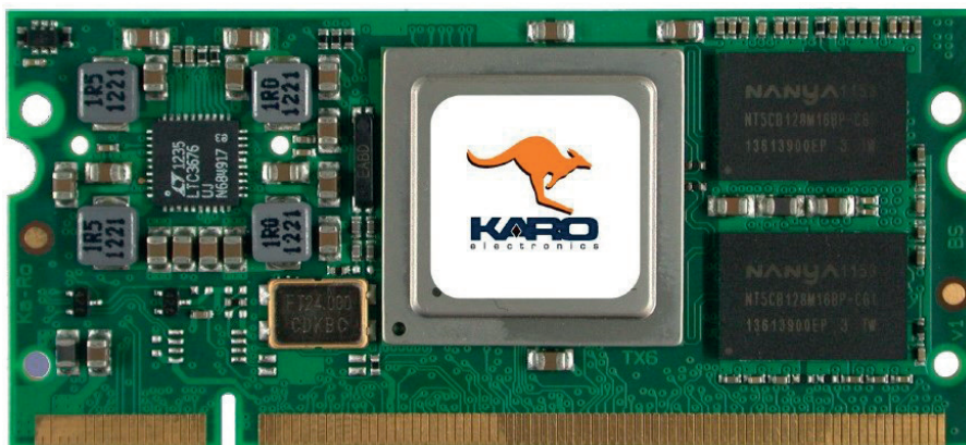
Rysunek 2. Przykład modułu CoM firmy Ka-Ro z rodziny TX
