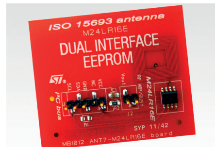
Fot. 5. Jedna z wersji opcjonalnej płytki z pamięcią RF EEPROM (M24LR)
