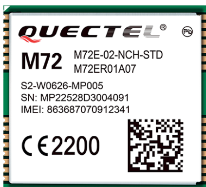
Fotografia 4. Moduł Quectel M72 wyłącznie do transmisji danych
