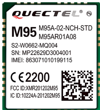
Fotografia 3. Moduł Quectel M95 do transmisji głosu i danych
