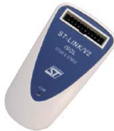
Fotografia 10. STMicroelectronics oferuje wariant programatora ST-Link/V2 z wbudowanym separatorem galwanicznym (ST-LINK/V2-ISOL)
