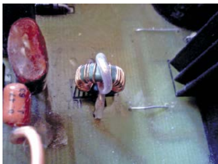
Fotografia 5. Wygląd zamontowanego przekładnika
