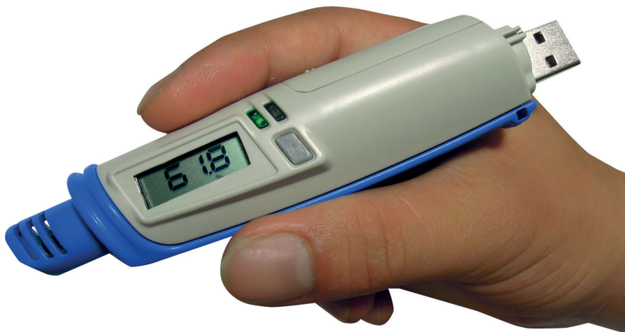
Fotografia 2. Rejestrator danych gromadzi dane dotyczące wilgotności i temperatury powietrza przez dłuższy czas i umożliwia analizę zebranych wartości w komputerze
