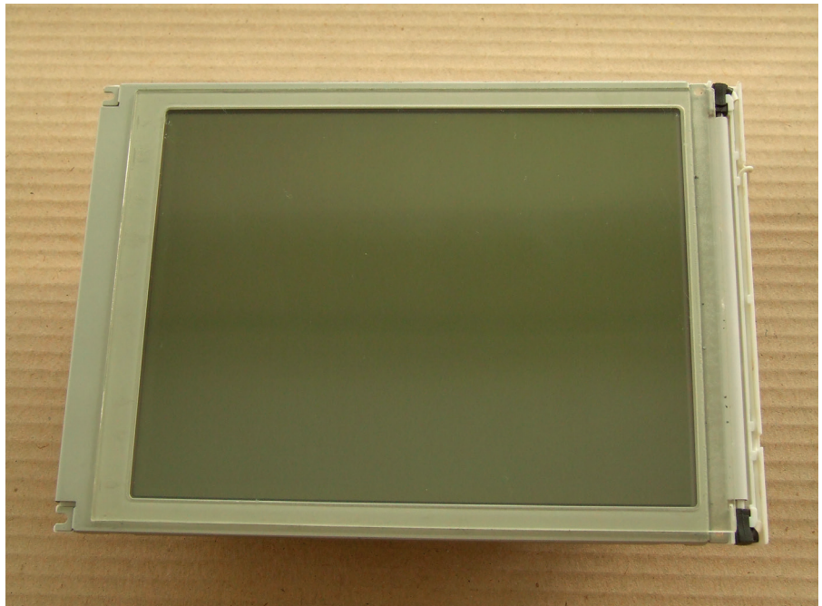
Fotografia 1. Wyświetlacz typu EG9018C firmy EPSON
