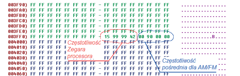
Rysunek 3. Zapis częstotliwości zegara procesora i częstotliwości pośrednie dla emisji AM i FM w pamięci Flash procesora.
