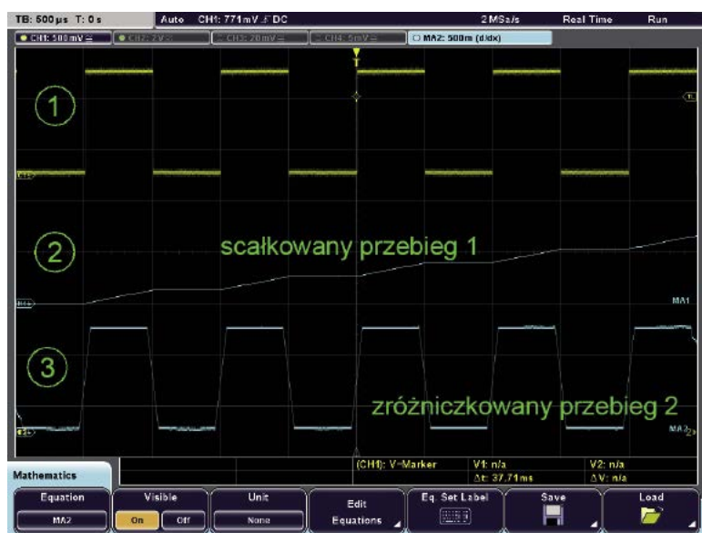
Rysunek 8. Oscylogramy uzyskane w wyniku zastosowania obliczeń matematycznych – całkowania i różniczkowania
