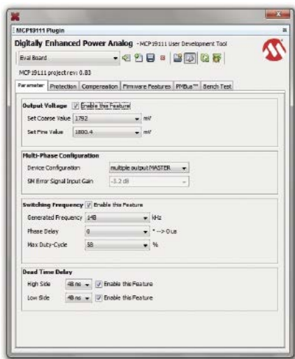
Rysunek 4. Narzędzie do konfigurowania układu MCP19111
