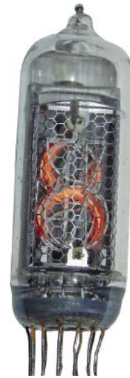
Fotografia 5. Efekt „zatrucia” katody spowodowany zużyciem się lampy
