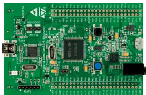
Fotografia 15. Wygląd zestawu STM32F4DISCOVERY z mikrofonem MP45DT02
