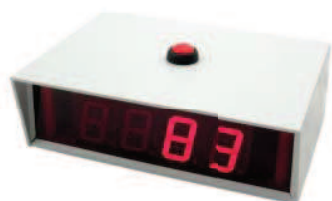
Fotografia 1. Wyświetlacz o wysokości znaków 27 mm w obudowie KM50
