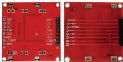
Fotografia 3. Różnice wyprowadzeń modułu LCD5110
