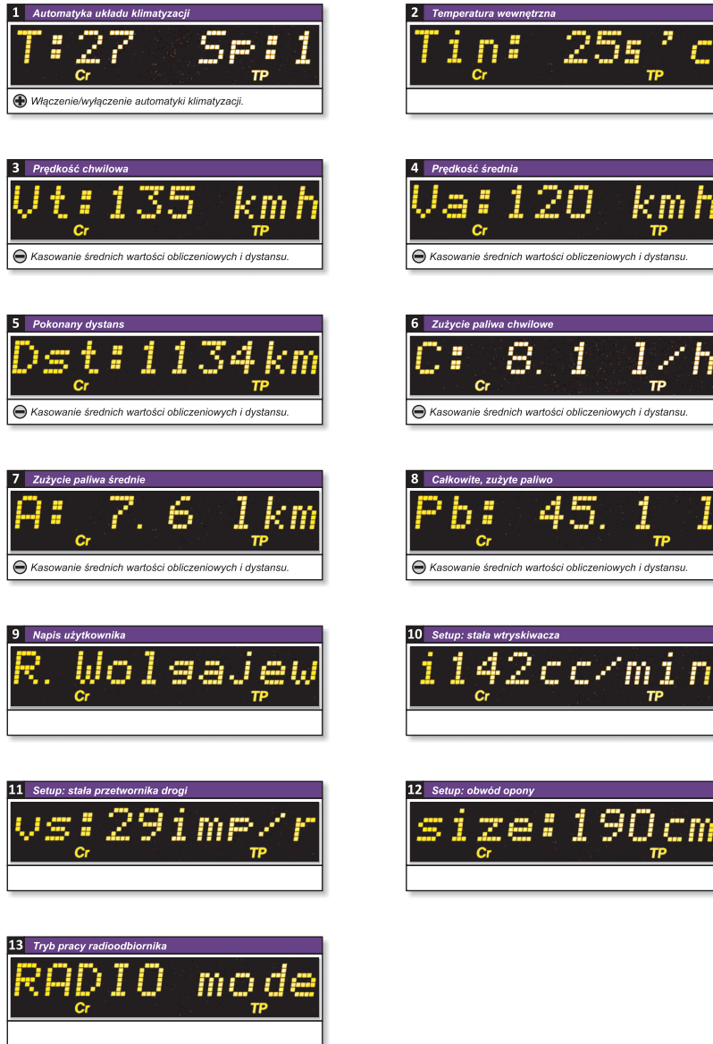
Rysunek 11. Dostępne tryby pracy sterownika TripCo wraz z opisem wyświetlanych wartości
