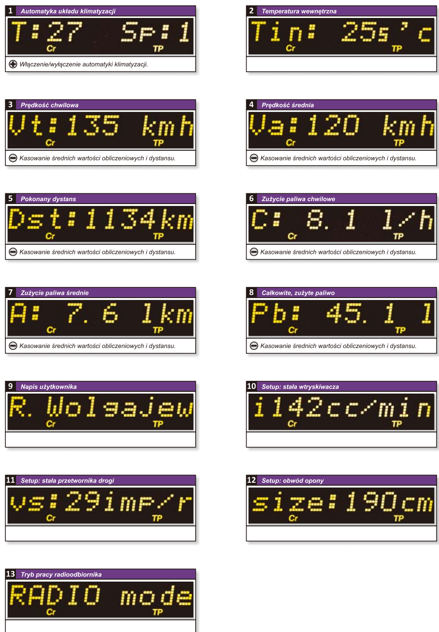
Rysunek 13. Dostępne tryby pracy układu TIDex wraz z opisem dodatkowej funkcjonalności elementów regulacyjnych
