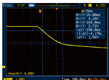
Rysunek 7. Wykres zależności napięcia podtrzymania w funkcji czasu w momencie wyłączenia zapłonu
