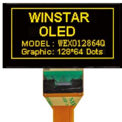
Fotografia 2. Wyświetlacz OLED monochromatyczny, graficzny typu WEG012864
