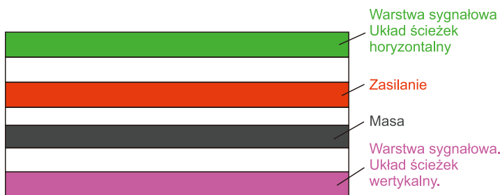
Rysunek 2. Ułożenie warstw w płytkach 4-warstwowych. Jest pożądane, aby warstwy sygnałowe były jak najbliżej płaszczyzny masy bądź zasilania
