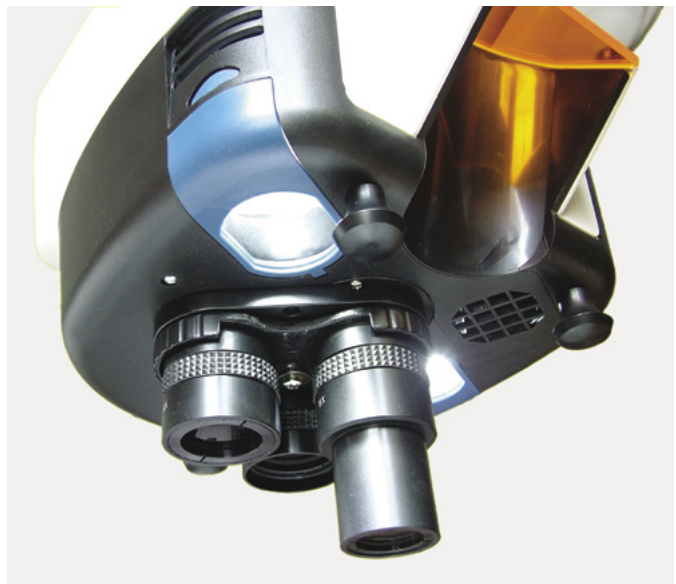
Fotografia 2. Głowica mikroskopu XDP-1 zawierająca 3 obiektywy
