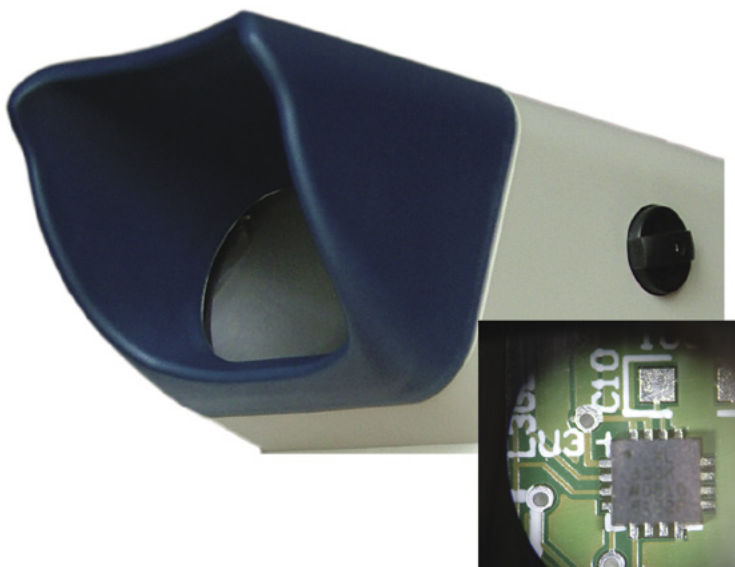
Fotografia 1. Okular mikroskopu XDP-1
