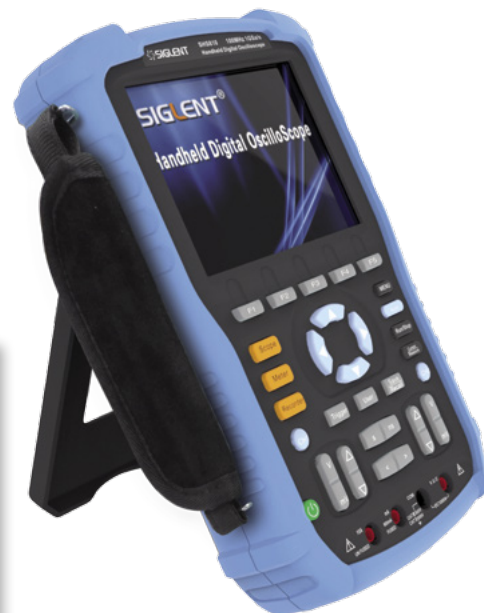
Fotografia 3. Skopometr Siglent SHS806 (60 MHz, 1 Gsa/s, 2 MB)
