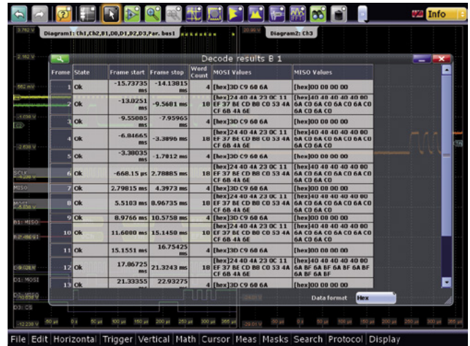
Rysunek 13. Tabelaryczna prezentacja wyników analizatora protokołu SPI
