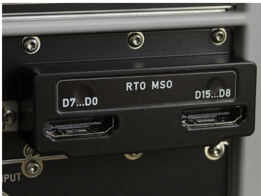
Fotografia 1. Wkładka MSO zamontowana w gnieździe znajdującym się na tylnej ścianie oscyloskopu
