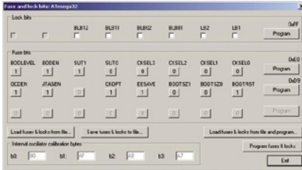
Rysunek 4. Ustawienie bitów bezpieczników mikrokontrolera
