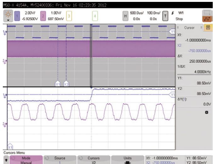
Rysunek 3. Możliwości funkcji Zoom oscyloskopu MSO-X 4154A
