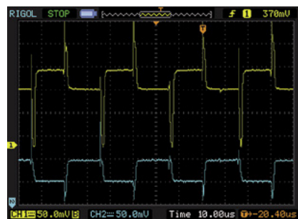
Rysunek 3. Przebieg na bramkach MOSFETów w półmostku
