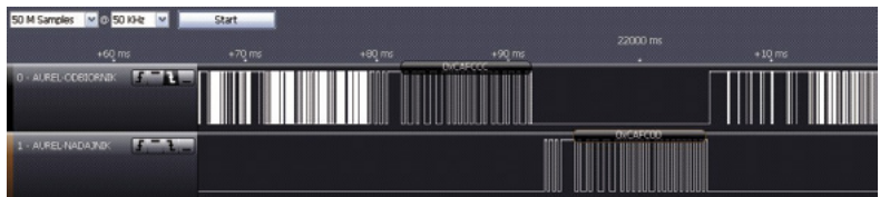
Rysunek 1. Rzeczywiste przebiegi sygnałów sterujących po stronie układu Slave dla przypadku zapytania o bieżące ustawienia jasności (rozkaz 0b1100)
